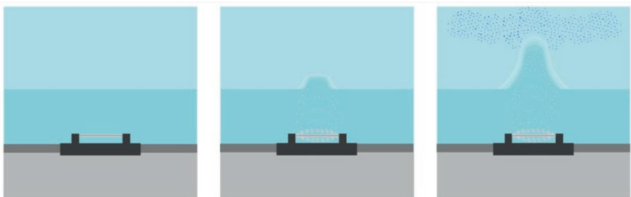
Abbildung 20: Funktionsprinzip Ultraschallvernebelung, Umlaufsprühbefeuchter bzw. Luftwäscher
