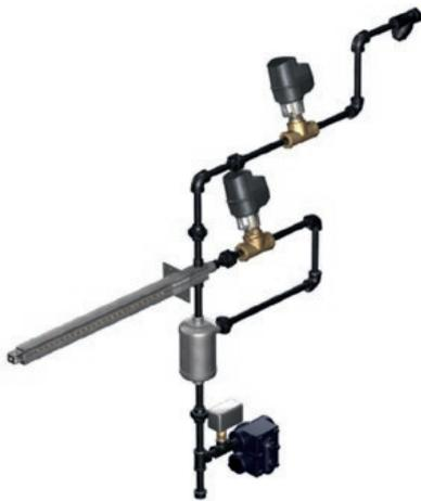
Abbildung 17: Fremddampfbefeuchter mit Dampftrockner, Regelventil, Stellantrieb und Dampfpflanze
