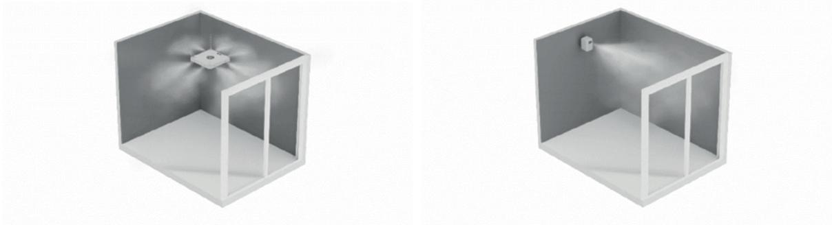
Abbildung 23: Hochdruck-Luftbefeuchter in der Decke (links) und an der Wand (rechts)
