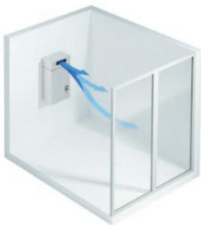
Abbildung 21: Direkte Raumluftbefeuchtung
