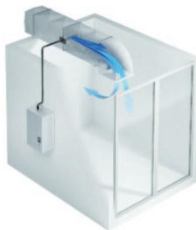
Abbildung 22: Indirekte Raumluftbefeuchtung
